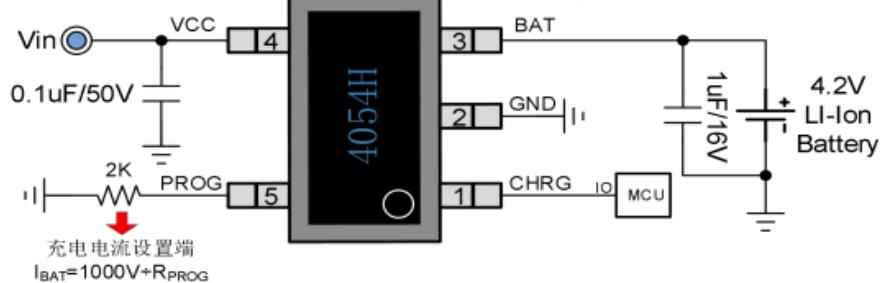
注 1：充电电流设置电阻最小不能小于2KΩ，精度±1%。
