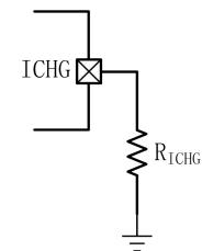
恒流充电阶段充电电流的大小  $I_{CC}$  和  $R_{ICHG}$  的关系通
