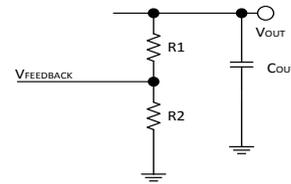
$$V_{OUT} = V_{FEEDBACK} \times \frac{R1 + R2}{R2}$$
